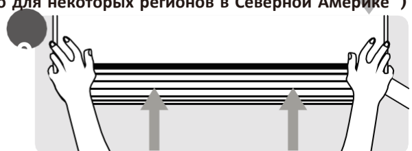
8 Обмотка трубопроводов и кабелей (не применимо для некоторых регионов в Северной Америке)
