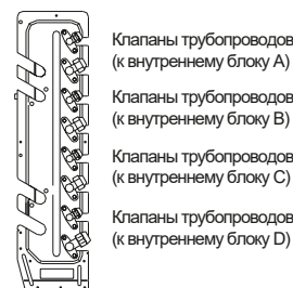
Рисунок 43 - Клапаны трубопроводов внешнего блока системы «1-4»
