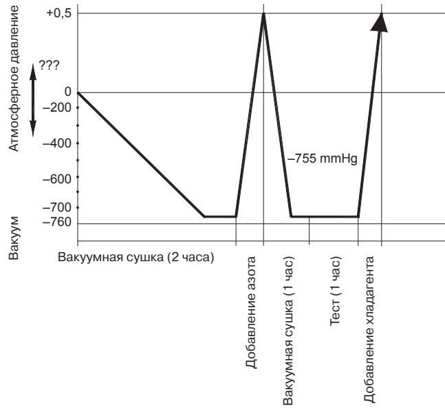
После первого вакуумирования добавьте в контур осущененный азот при давлении до 25 кг/см<sup>2</sup> на 30 минут. Удалите азот и снова отвакуумируйте систему. После проверки на утечку добавьте хладагент.
